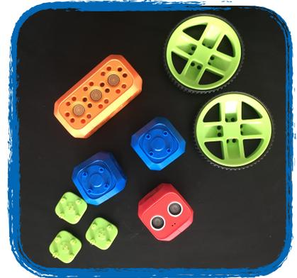
1. Für das Fahrzeug werden die Motoren (blau) mit den Verbindungsstücken (grün) am Computer (orange) befestigt. Dabei ist darauf zu achten, dass die elektrisch leitenden Bauteile nicht durch nicht-leitende Materialien verdeckt werden. Damit das Fahrzeug fahren kann, müssen die Räder an die Motoren angebaut werden.
