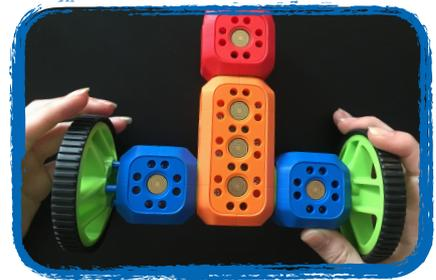
2. Um den Abstandssensor (rot) benutzen zu können, wird dieser ebenfalls mithilfe eines Verbindungsstücks am Computer befestigt. Damit das Fahrzeug kein Übergewicht nach vorne hat, wird ein zusätzliches kleines Rad an der Unterseite befestigt.
